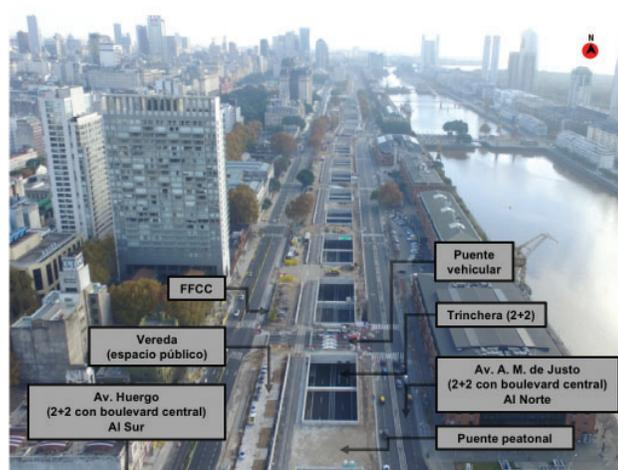
**Figura 12:** Imagen aérea de la trinchera y sus elementos.
